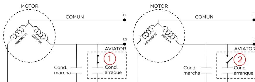
En arranques tradicionales el relé de arranque se acciona por la tensión que atraviesa el bobinado de arranque que desconecta el capacitor de arranque una vez que el motor ha partido.
